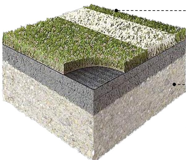
**Fibre :** Polyéthylène avec remplissage de sable de quartz
